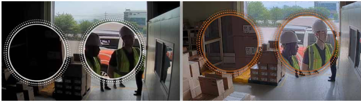
Imagen 2. Comparación WDR convencional (izquierda) y WDR extremo Wisenet7 (derecha)
