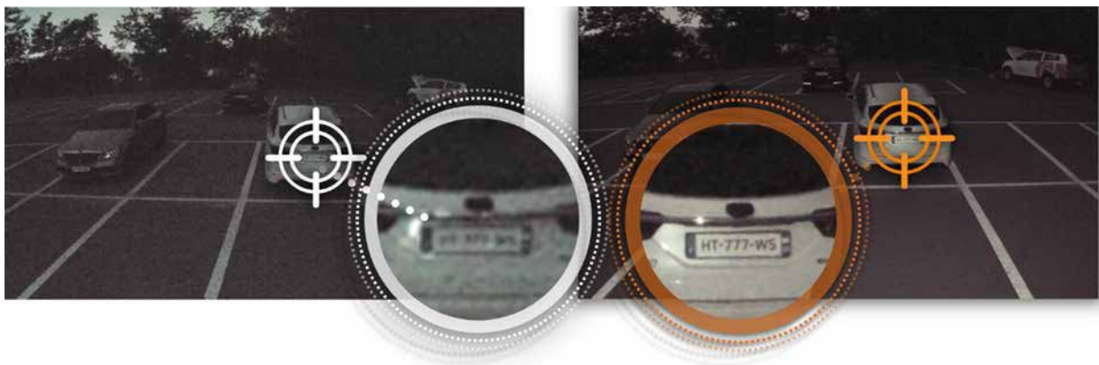
Imagen 3. Comparación de la reducción de ruido convencional (izquierda) y de la reducción de ruido Wisenet7 Wise NR (derecha)
