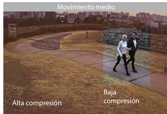
WiseStreamII Desconectada: 7260kbps WiseStreamII Encendida: 1817kbps
