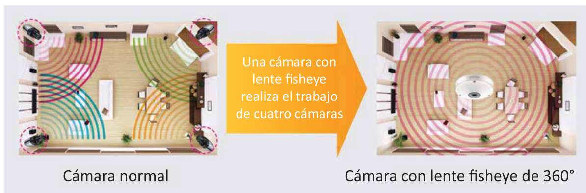
Figura 1. Comparación de área de monitoreo entre cámara con lente fisheye y cámara normal
