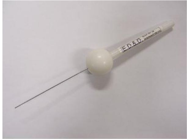
Test Rod Probe Ø1.0
