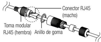
4. Instale girando la toma modular RJ45 (hembra) y la cubierta de protección RJ45 hacia la derecha (siga la flecha).
