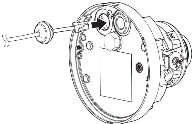
6. Conecte el cable de red al puerto PoE del cuerpo de la cámara.
