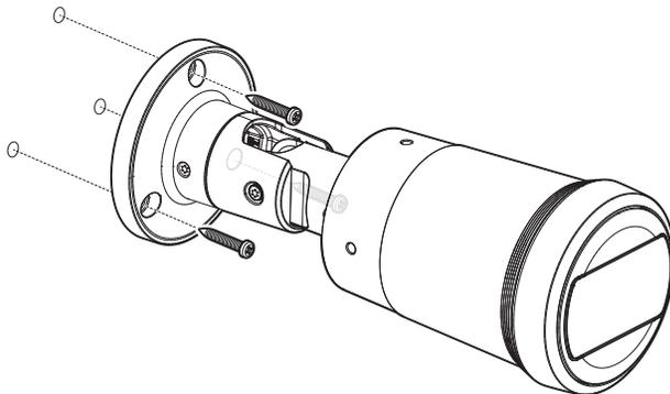
4. Afloje los tornillos de fijación de cada parte de control para ajustar la dirección de vigilancia de la cámara.
