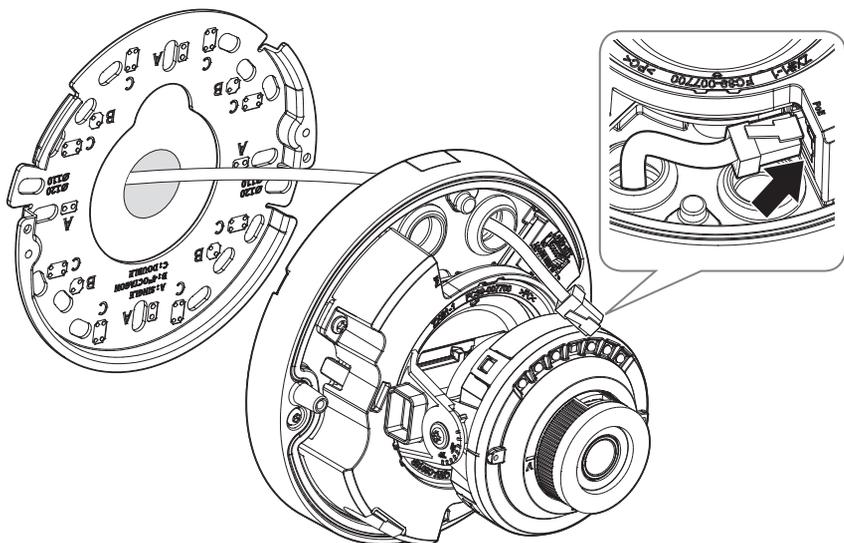
[Instalación de cables de audio/alarma (se vende por separado)]
