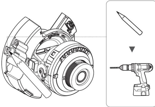
2. Fije el cuerpo de la cámara utilizando los tornillos adecuados.
