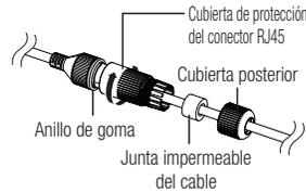
5. Instale girando la cubierta de protección RJ45 y la cubierta posterior hacia la derecha (siga la flecha). Cuando se instala la cubierta posterior, la junta impermeable de cable se conecta firmemente al cable para hacerla impermeable.
