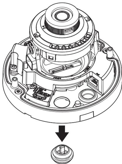
2. Retire la parte saliente del conector del cable de 1 orificio que se retiró del cuerpo de la cámara.
