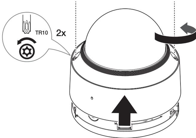
2. Retire la cubierta de fijación del cuerpo de la cámara.
