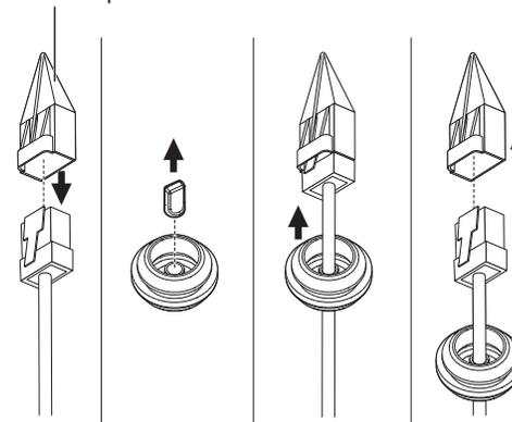
4. Para garantizar una protección a prueba de agua, tire del cable por debajo del pasacables, como se muestra en la siguiente figura.
