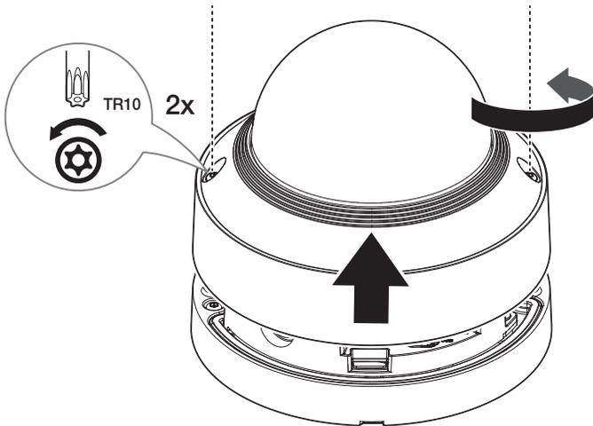
2. Retire el cuerpo de la cámara girando los tornillos de fijación de la placa de montaje en sentido contrario a las agujas del reloj.
