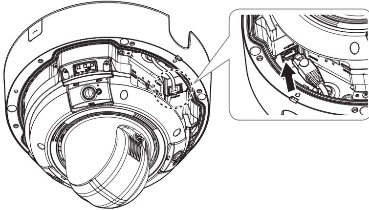
9. Fije el cuerpo de la cámara, apretando los tornillos de fijación del cuerpo de la cámara.
