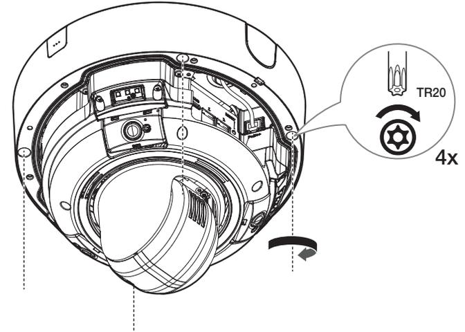
8. Levante el cuerpo de la cámara y empuje los clips de montaje hasta que encajen en sus lugares.
