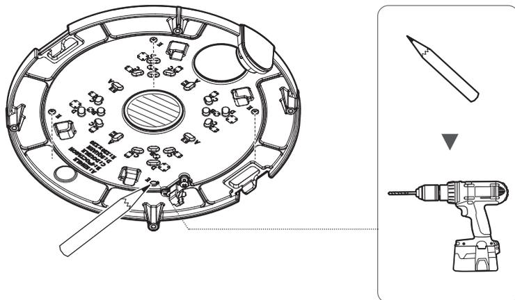
1-2. Asegure la placa de montaje con los tornillos apropiados.
