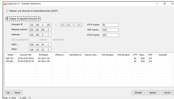
1. Haga clic en la cámara de la lista para la que desea cambiar el ajuste de la IP.
