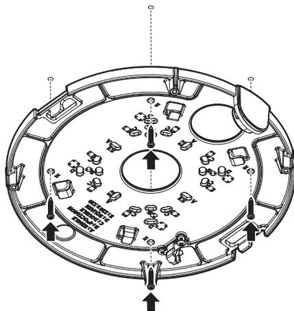
1-3. Saque el cable de red por el agujero de la placa de montaje.
