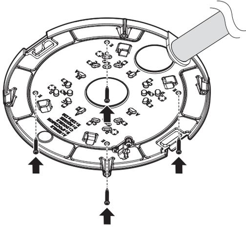
2-5. Retire los cables necesarios entre los cables de red y de alarma a través de la tubería.
