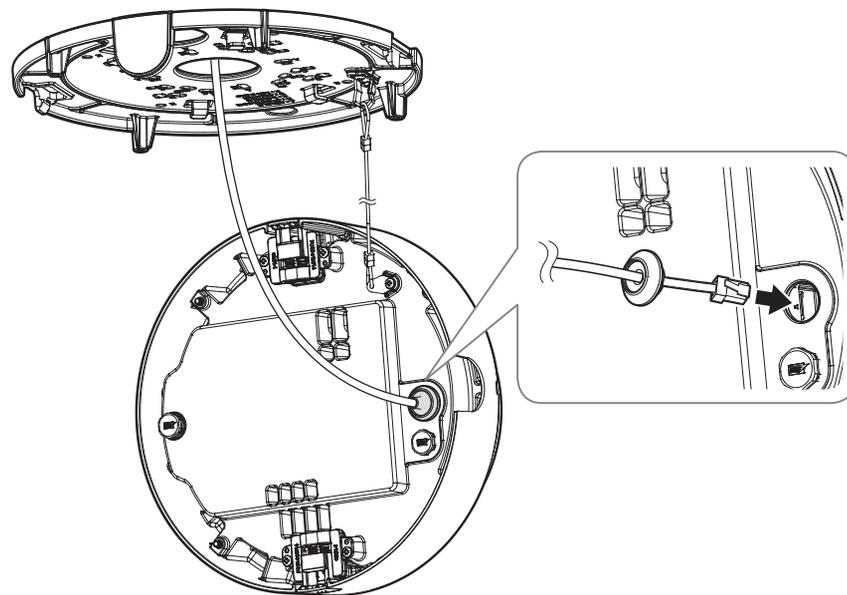
7. Acople el conector del cable de red al puerto PoE++ de la cámara.
