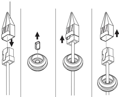
5. Para garantizar una protección a prueba de agua, tire del cable por debajo del pasacables, como se muestra en la siguiente figura.
