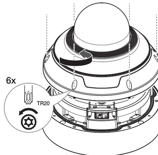
2. Después de aflojar los tornillos de fijación del cuerpo de la cámara. Retire la placa de montaje después de presionar los botones en ambos lados, como se muestra en la figura.
