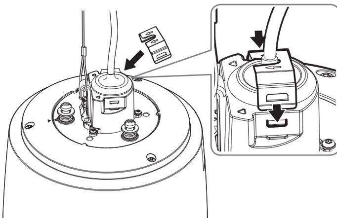
5. Después de alinear las guías de dirección de dirección del soporte colgante, empuje la cubierta principal hacia arriba y gírela en sentido antihorario hasta que quede asegurada.
