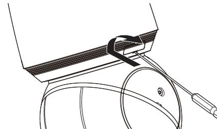
3. Inserte las tarjetas Micro SD en la dirección de las flechas como se muestra en la figura.
