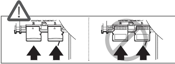
4. Después de insertar las tarjetas Micro SD, empuje la ranura de la tarjeta Micro SD hasta que encaje en su lugar.
