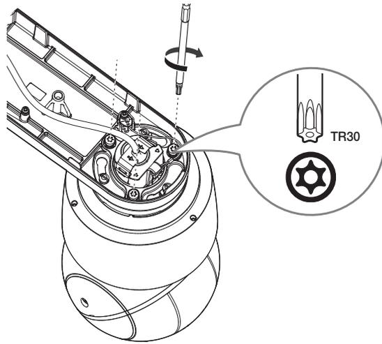
7. Junte la cubierta superior del soporte de muro y de poste.
