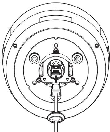
3. Introduzca el pasacables del cable de red en el orificio. Al introducirlo, presione uniformemente toda el área del pasacables para que quede bien encajado.
