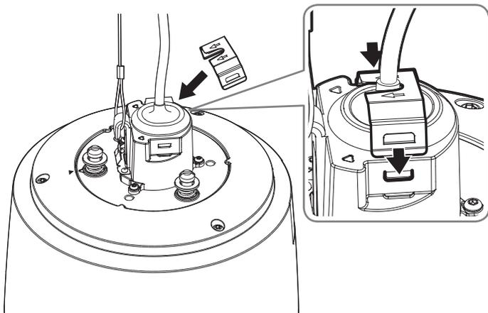
5. Después de alinear las guías de dirección de instalación de la cámara y el soporte de muro y de poste, empuje la cubierta principal hacia arriba y gírela en sentido antihorario hasta que quede asegurada.
