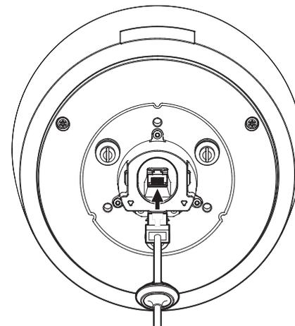
4. Introduzca el pasacables del cable de red en el orificio. Al introducirlo, presione uniformemente toda el área del pasacables para que quede bien encajado.
