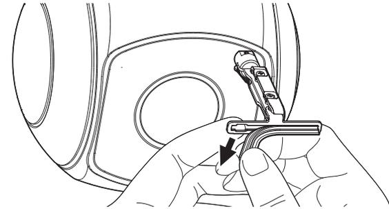
4. Inserte el reemplazo de goma en la ranura de junta, deslizando en la dirección de la flecha.
