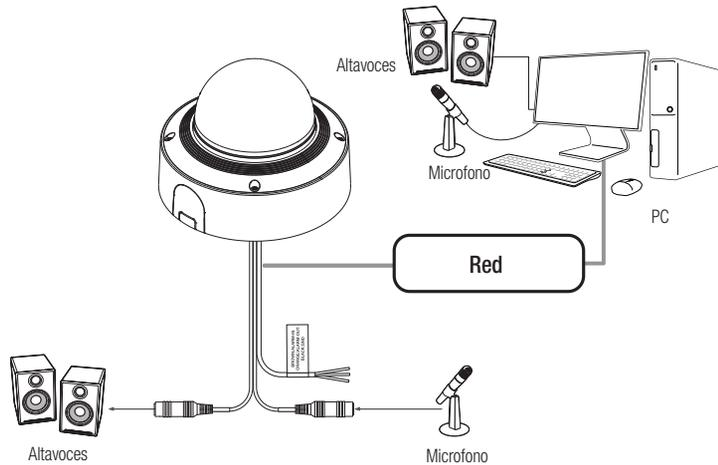
1. Conecte el puerto MIC de la cámara con el micrófono o al puerto LINE OUT del amplificador al que está conectado el micrófono.
