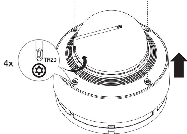
2. Use la llave Torx L suministrada para girar los tornillos de la placa de montaje en sentido antihorario para liberar el cuerpo de la cámara.
