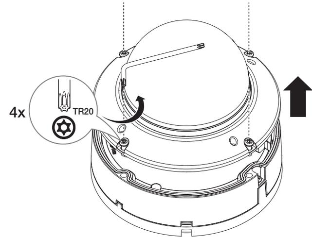
3. Use la llave Torx L suministrada para girar los tornillos de la placa de montaje en sentido antihorario para liberar el cuerpo de la cámara.
