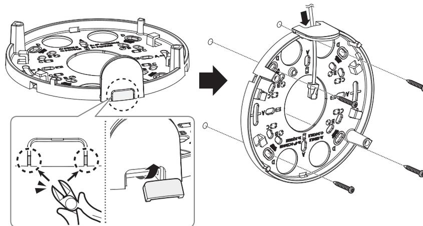
1-2. Asegure la placa de montaje con los tornillos apropiados.
