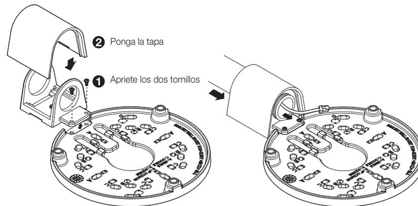
2-4. Asegure la placa de montaje con los tornillos apropiados.
