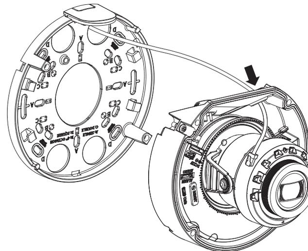
[Instalación de cables de audio/alarma]
