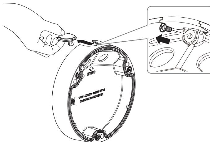
2-2. Fije el adaptador de tubos (se vende por separado) a la placa de montaje.
