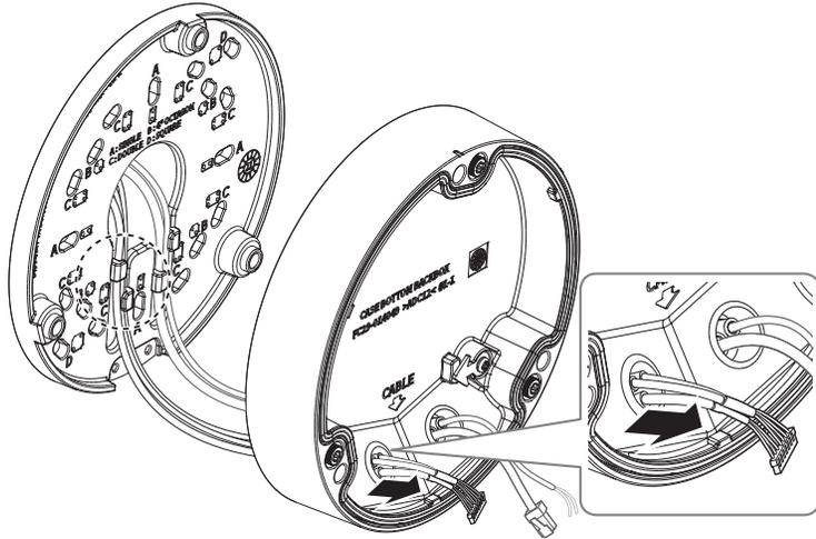
4. Una la placa de montaje con la tapa inferior.
