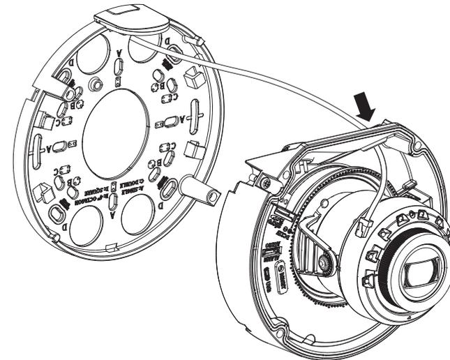
[Instalación de cables de audio/alarma]
