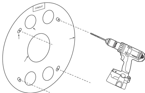
☑ Cuando conecte el cable por el costado, retire primero la tapa del orificio de cableado antes de hacerlo.
