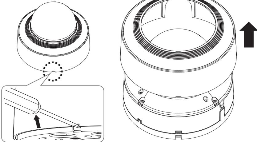
2. Use la llave Torx L suministrada para girar los tornillos de la cubierta del domo en sentido antihorario para liberar la cubierta.
