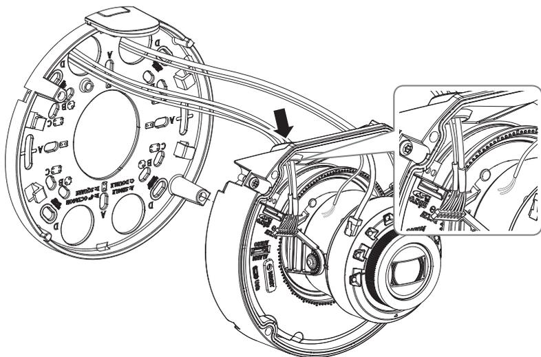
5. Conecte los cables de red/alimentación/audio/alarma al terminal en el cuerpo de la cámara.
