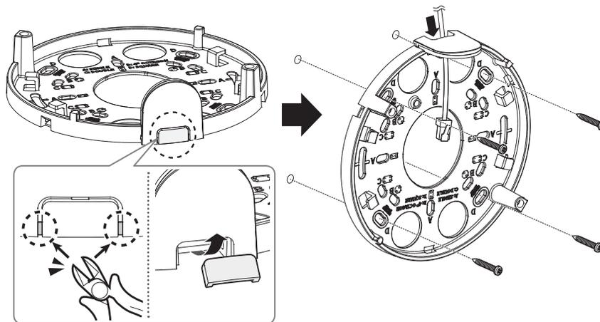
1-2. Asegure la placa de montaje con los tornillos apropiados.
