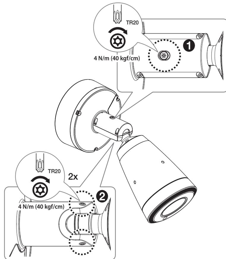
6. Use los tornillos de montaje del protector solar y las arandelas dentadas para unir el protector solar al cuerpo de la cámara.
