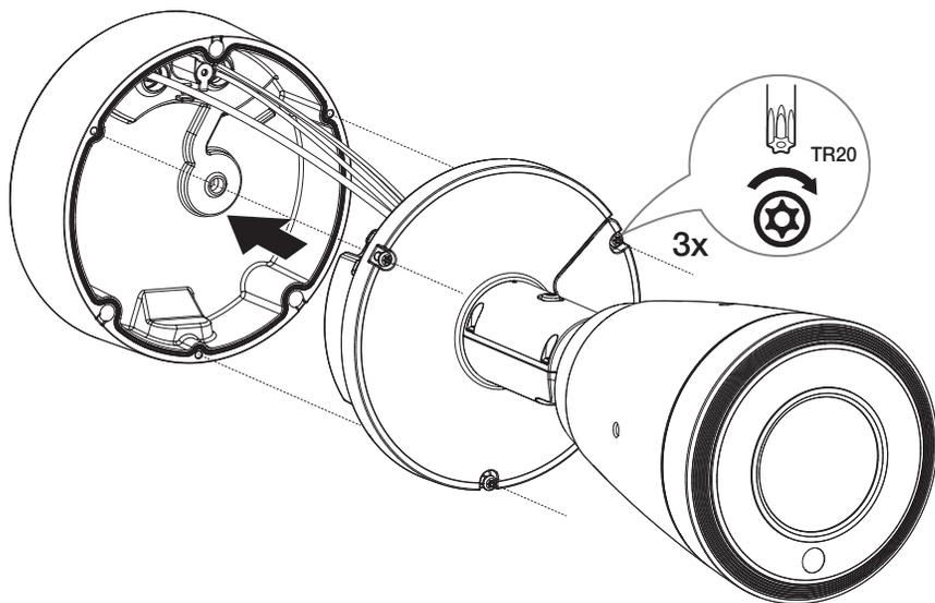
4. Retire el tornillo de ajuste de dirección del cuerpo de la cámara con una llave Torx u otra herramienta para ajustar la dirección de la cámara.
