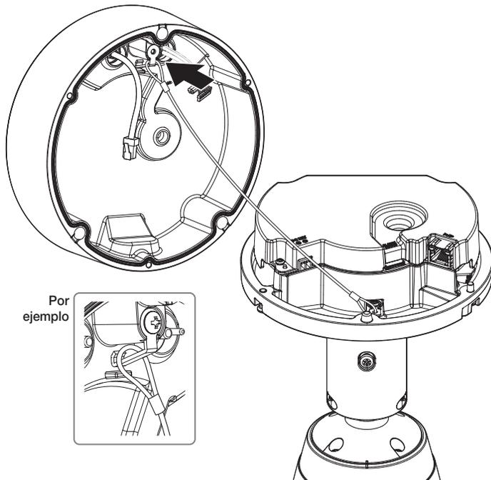
2. Conecte los cables de red/alimentación/audio/alarma al terminal en el cuerpo de la cámara.
