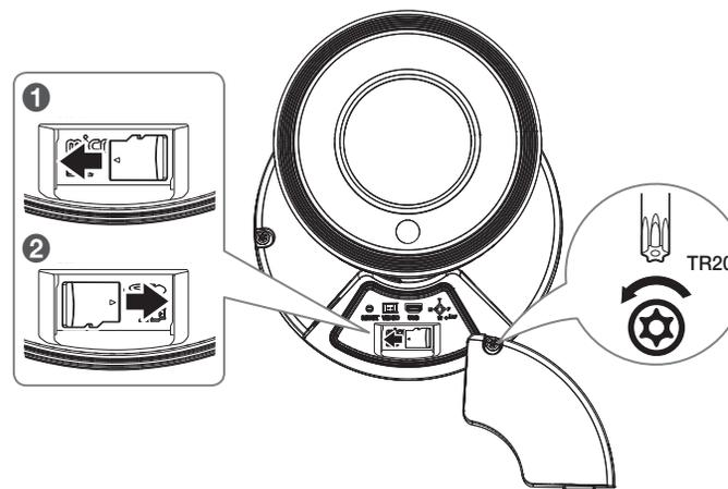
3. Coloque la tapa de la ranura para la tarjeta micro SD, y después apriete el tornillo para montarla.
