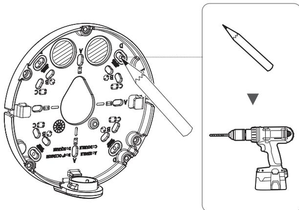
1-2. Fije la placa de montaje usando los tornillos apropiados.
