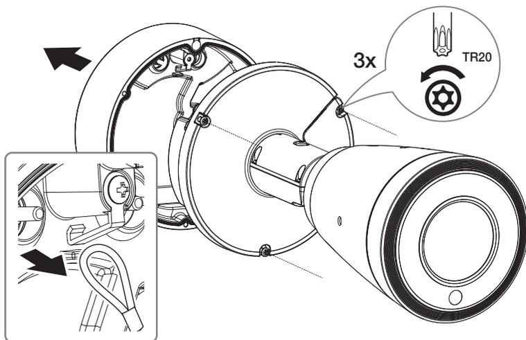
2. Retire la cinta adhesiva de la tapa inferior y la placa de montaje, y después retire la placa de montaje.
