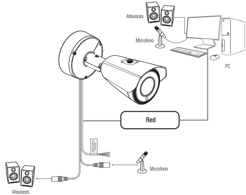
1. Conecte el puerto MIC de la cámara con el micrófono o al puerto LINE OUT del amplificador al que está conectado el micrófono.
